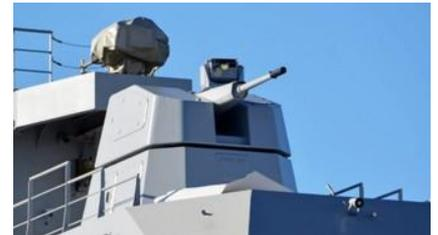
Ce n'est pas la première fois que ce « canon » laser, autrement appelé arme à « énergie dirigée », conçu par Cilas est mis en œuvre. Lors d'essais sur terre, il avait pu abattre des drones distants de 1 000 mètres en moins de dix secondes. Il est censé pouvoir atteindre des modèles pesant de 100 grammes à 25 kilos en les brûlant.
